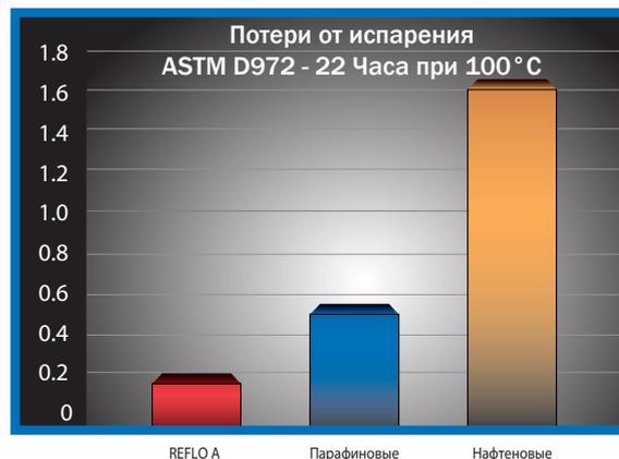
Более низкая летучесть масел REFLO A снижает перенос частиц масла парами, который часто наблюдается при использовании парафиновых и нефтяных масел. В связи с этим расход компрессорного масла снижен на 80%.
